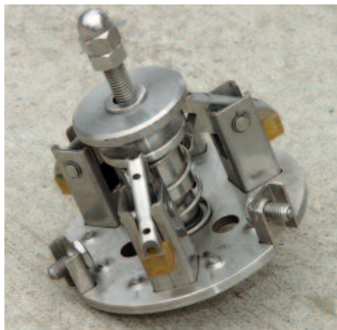
4. À la fin du forage, sous l'effet du poids de la carotte, l'appareil se bloque contre la paroi de l'outil diamanté et empêche la carotte de béton de chuter.
